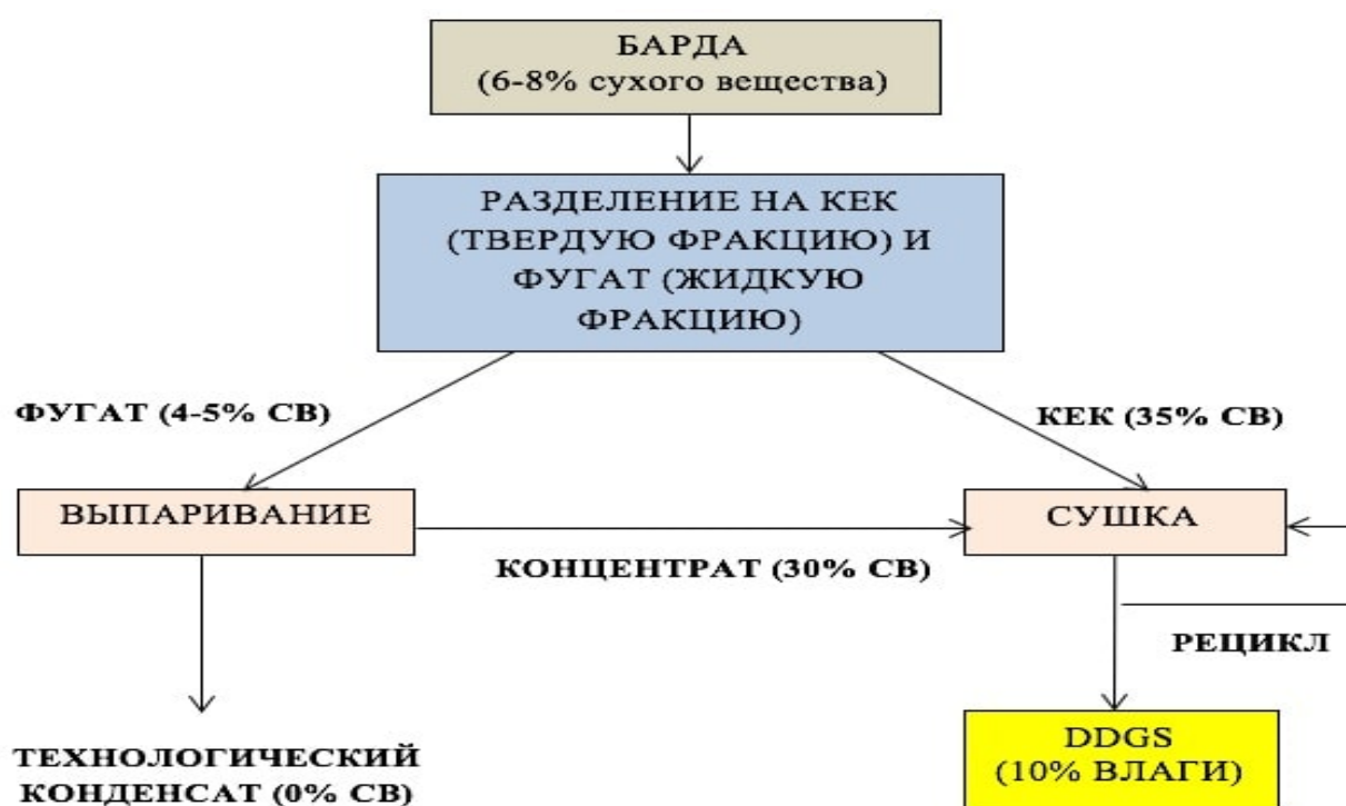
Рисунок 1– Схема полной переработки спиртовой барды с получением DDGS
